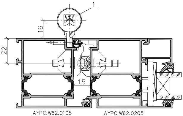
1 – петля роликовая Alutech R6272IN с комплектом крепления
