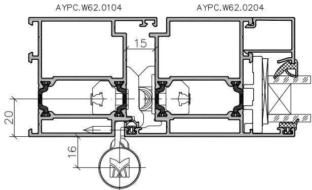
1 – петля роликовая Alutech R62OUT с комплектом крепления
